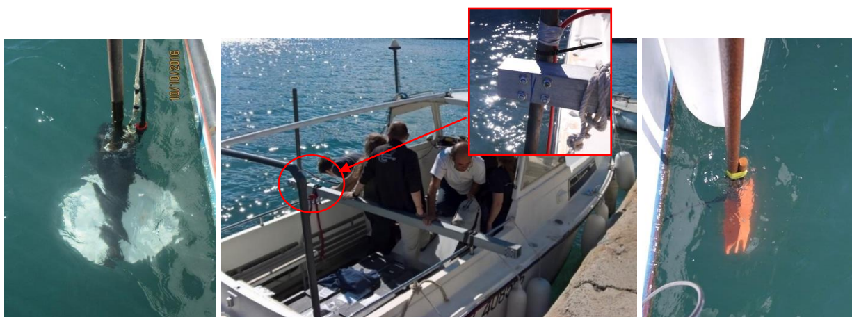
Le bateau équipé de la traverse porte instruments (au centre), le sondeur (bâbord) et le sonar (tribord) à poste.
